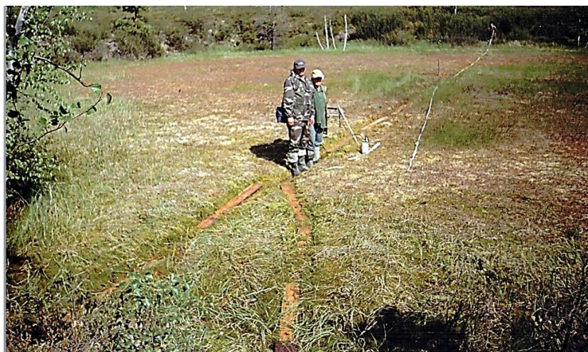
Рисунок 14. В.В. Копейкин и В.А. Алексеев проводят георадарную съёмку Сусловской воронки георадаром «Лоза». Фото Н.Г. Алексеевой.
